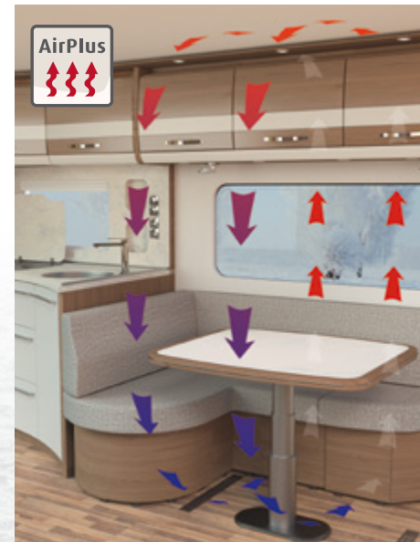
AirPlus-ilmankiertojärjestelmä estää kondenssiveden muodostumista
