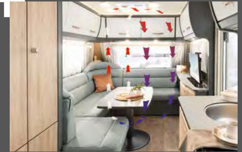
AirPlus-järjestelmän ansiosta ilma kiertää sisätiloissa yläkaapistojen takaa.
