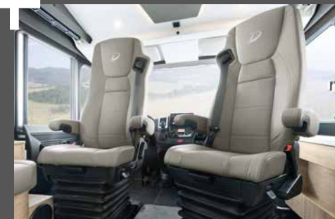
Vieläkin mukavampaa: Ilmajousitetuissa SKA-pilotti-istuimissa on lämmitys ja istuinosan tuuletus (lisävaruste integroituissa malleissa)
