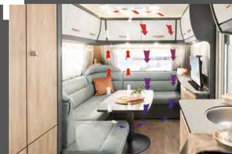
AirPlus-järjestelmän ansiosta ilma kiertää sisätiloissa yläkaapistojen takaa.
