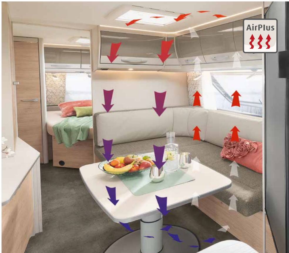
AirPlus-rakenne kierrättää ilmaa yläkaapistojen takaa ja estää siten kondenssiveden muodostumista
