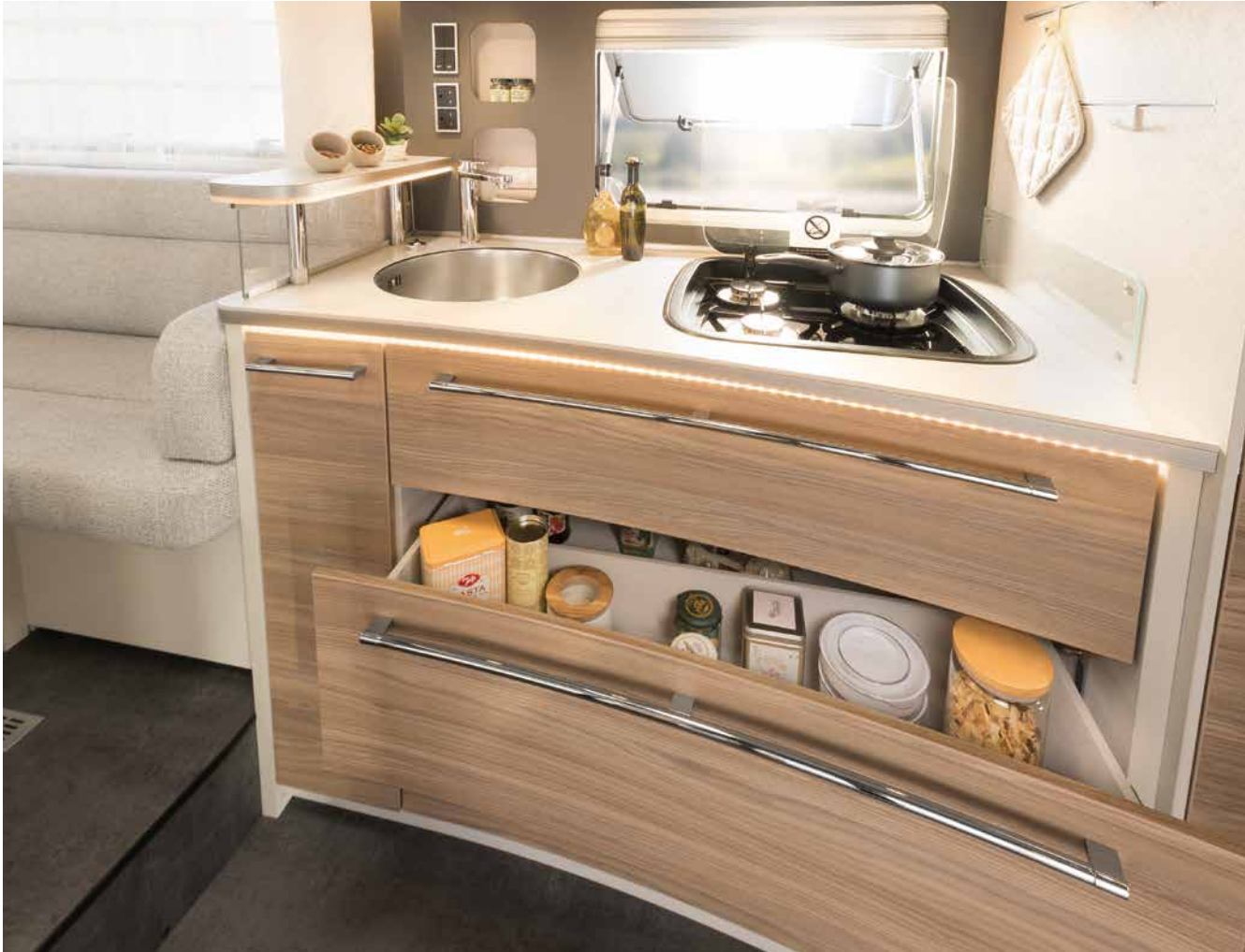
Suurissa vetolaatikoissa on keskuslukitus, joka lukitsee laatikot moottorin käynnistyessä
