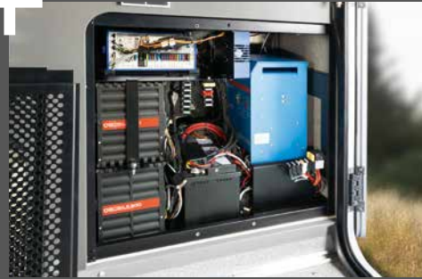
Enemmän vapautta ja riippumattomuutta uusimman litiumioni-akkutekniikan ansiosta, yhdistettynä 1600 W tai 3000W invertteriin (lisähinta)
