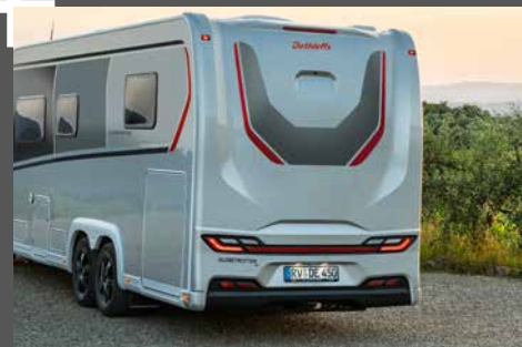
Sporttisesti muotoiltu takapää hyvin eristävää lasikuitua sekä takaspoileriin integroitu peruutuskamera ja lisäjarruvalo
