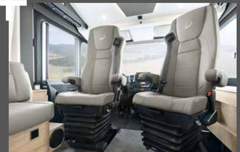
Mukavaa ja tasaista matkantekoa: Ilmajoustitetut istuimet on saatavana myös istuinlämmityksellä ja istuinosan tuuletuksella (lisävaruste)
